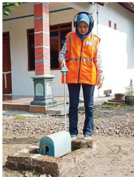
Penggunaan listening stick untuk mengidentifikasi kebocoran fisik.
