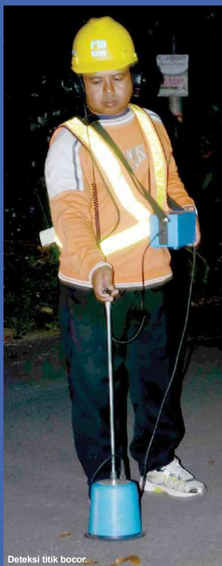
Deteksi bocor dengan noise logger.
